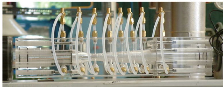
Figura 11 – Fotografia do tubo de Venturi
