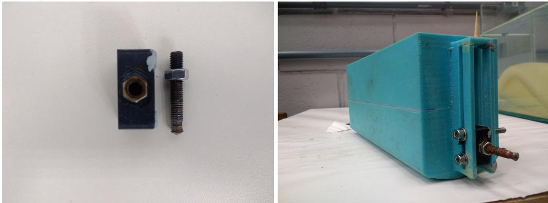
(a) Peça de acoplamento e parafuso. (b) Peça de acoplamento montada no modelo.
