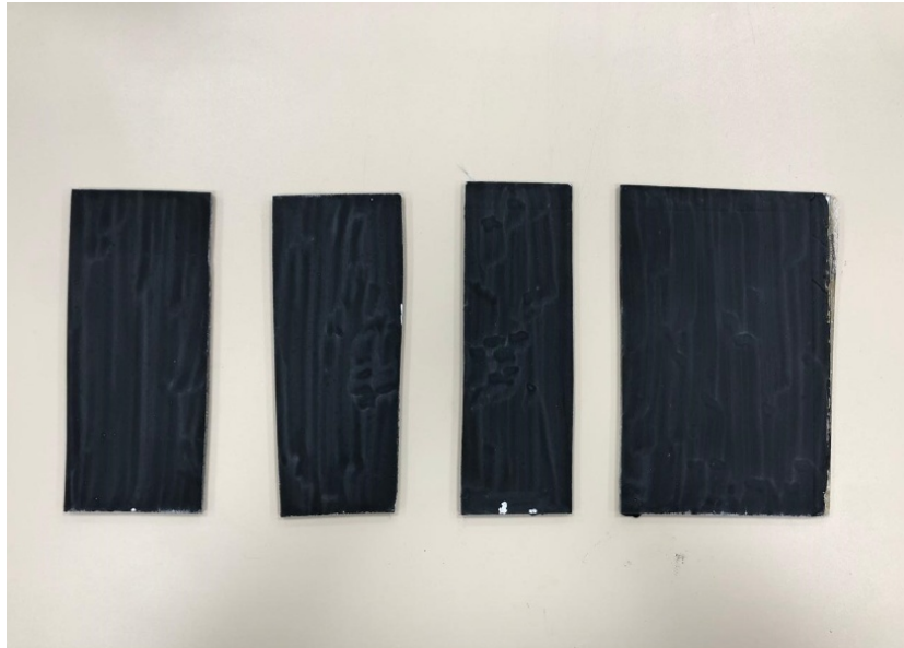
Figura 21 – Laminados com vazios de 30, 20, 10 e 5mm, respectivamente
