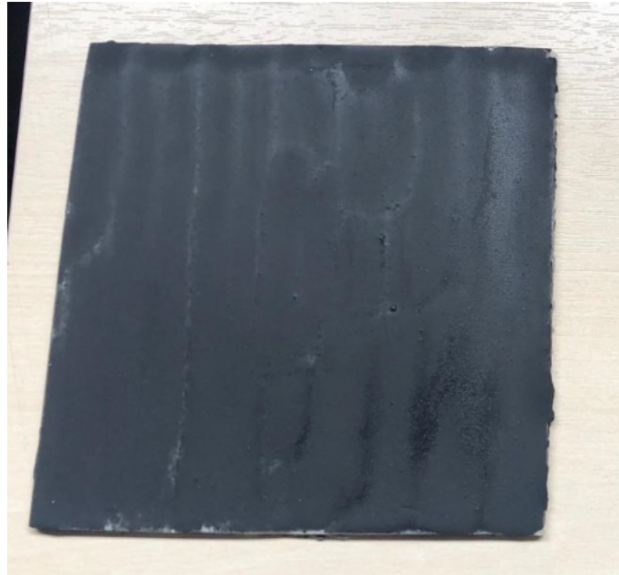
Figura 18 – Laminado com a tinta de alta emissividade
