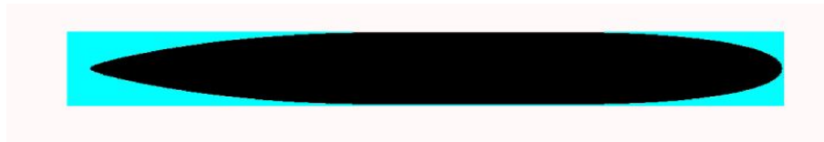
Figura 39 – Planificação da embarcação a partir da matriz de pontos- Eixo [x,y]
