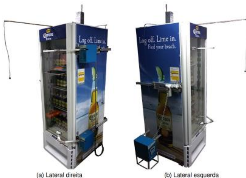
Figura 11 Termopares para leitura da temperatura ambiente 8 .
