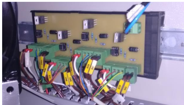
Figura 5.9 - Placa de circuito integrado de acionamento e medição de potência das eletroválvulas
