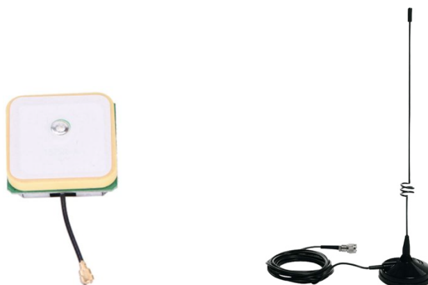
Figura 27 – GPS (esquerda) e Antena de transmissão (direita).
