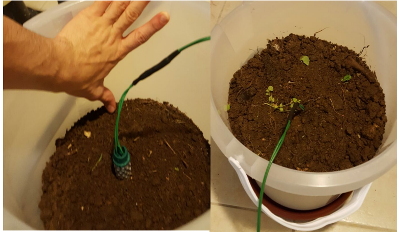
Figura 36 - Instalação do Sensor Watermark
