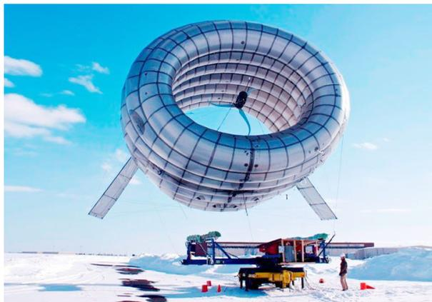
**Figura 3.2:** Sistema aerogerador estático desenvolvido pela empresa Altaeros Energies.
