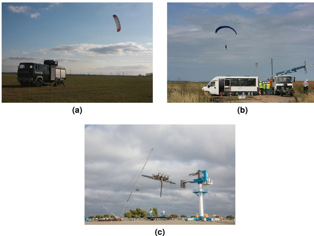
**Figura 1.2:** Exemplos de sistemas aerogeradores com aerofólios cabeados. (a) Empresa Enerkite; (b) Empresa Kite Power Systems (KPS); (c) Empresa Makani Power.
