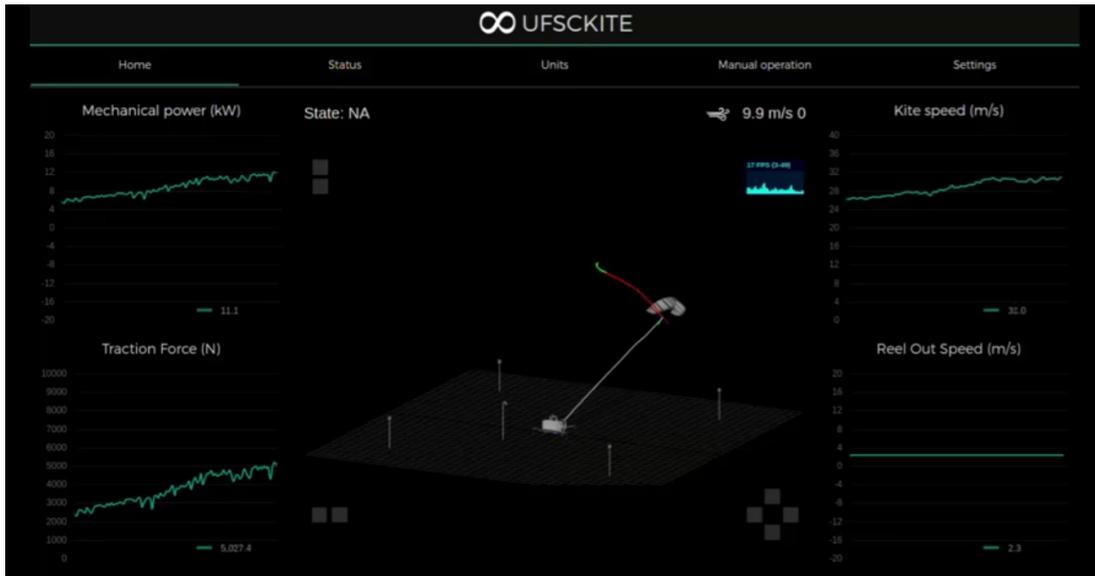
**Figura 4.2:** Imagem obtida da tela principal do sistema supervisor.
