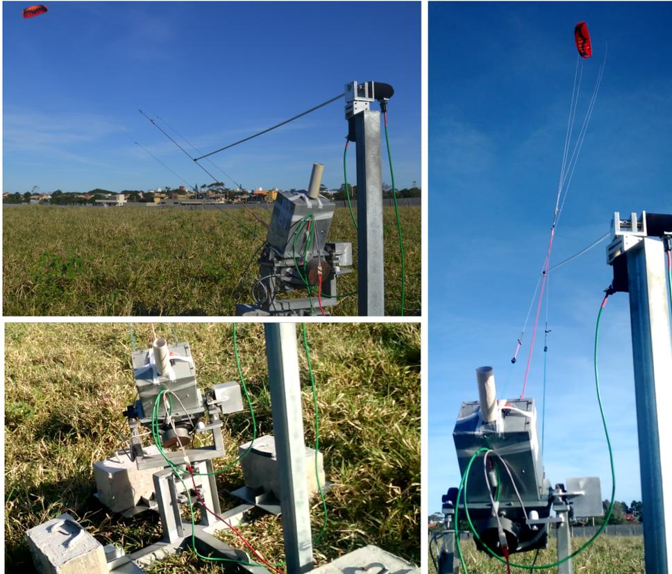
**Figura 4.1:** Protótipo desenvolvido pelo grupo UFSCkite a fim de testar, aprimorar e validar as estratégias de controle desenvolvidas.
