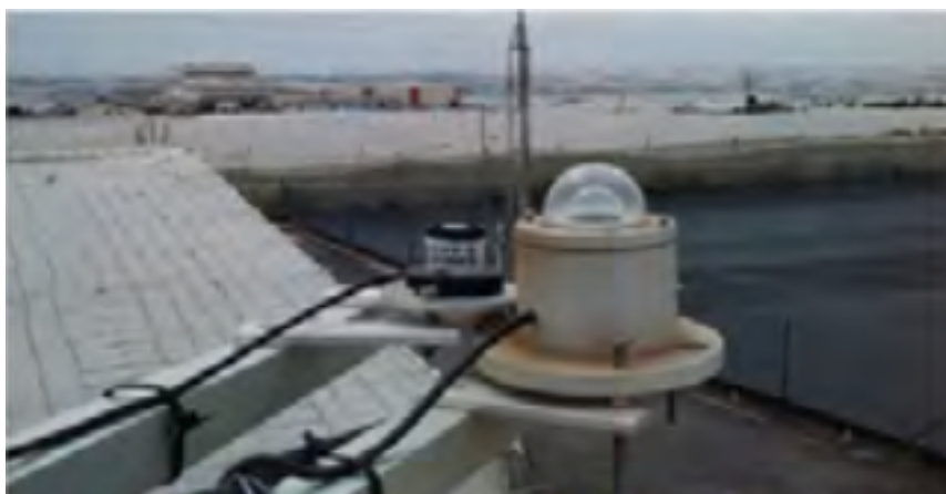
Figura 10 – Foto do sensor de radiação solar e fotossintética no exterior da estufa
