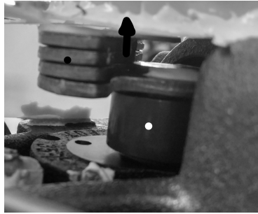
Figura 17 – Montagem da estrutura de acoplamento entre o cabeçote e o eixo do encoder
