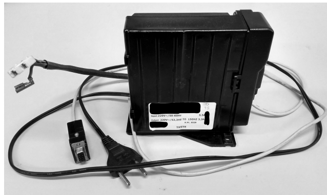
Figura 10 – Inversor de frequência utilizado para acionar o compressor
