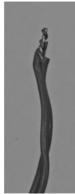
Figura 23 – Junção do termopar tipo T utilizado no trabalho.
