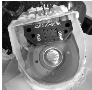
Figura 18 – Vista superior do encoder acoplado ao cabeçote.
