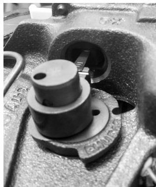
Figura 4 – Mecanismo biela manivela que acopla o eixo do rotor ao pistão do compressor
