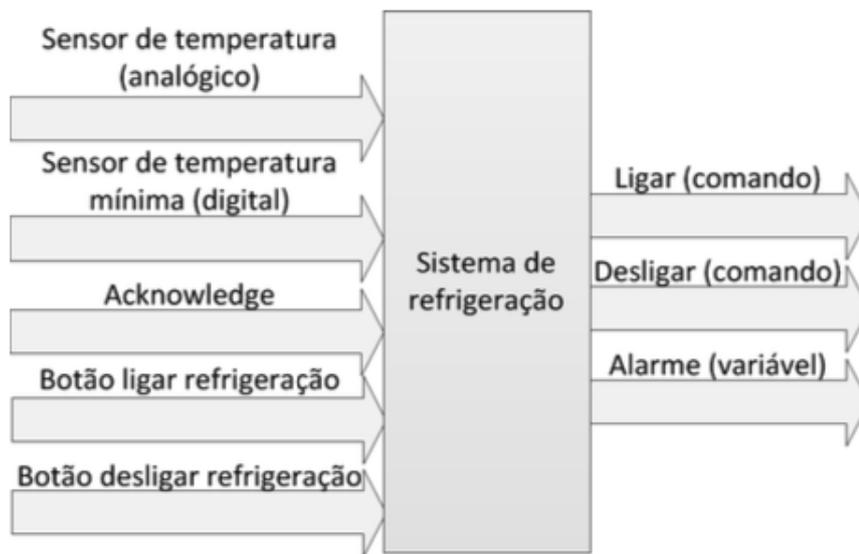
Figura 53 – Entradas e saídas do subsistema sistema de refrigeração
