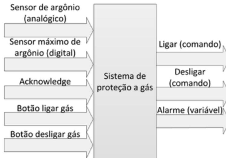
Figura 60 – Entradas e saídas do subsistema sistema de proteção a gás
