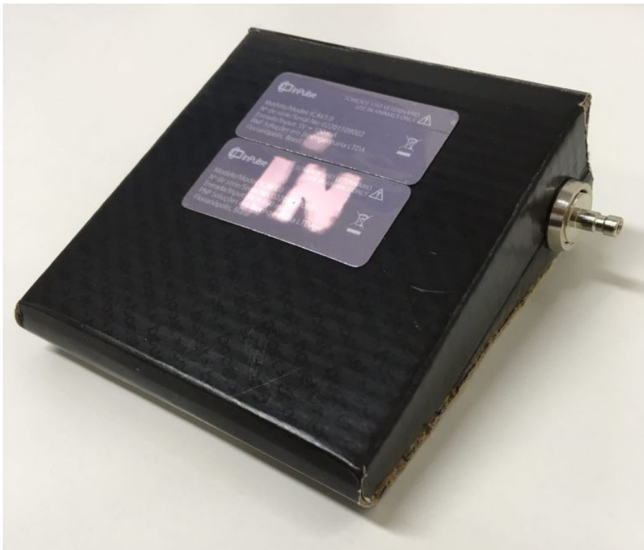
Figura 7 – Protótipo do case com a placa em seu interior, validando a possibilidade de utilização do mesmo sem interferir no design.
