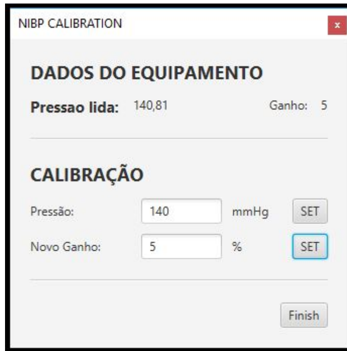
Figura 22 – Tela de calibração: setar valor de pressão.
