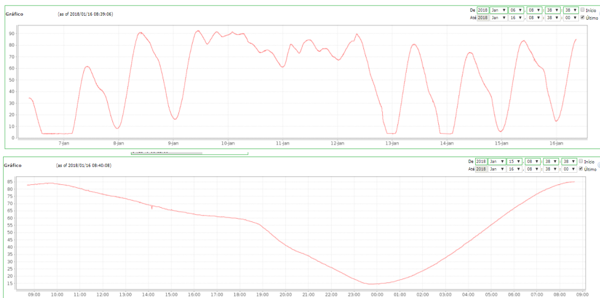
Figura 11 - Variação do nível do reservatório cachoeira (%)
