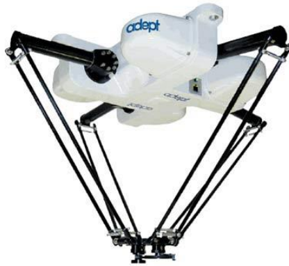
Figura 6 - Robô paralelo com uma configuração de cadeia fechada.
