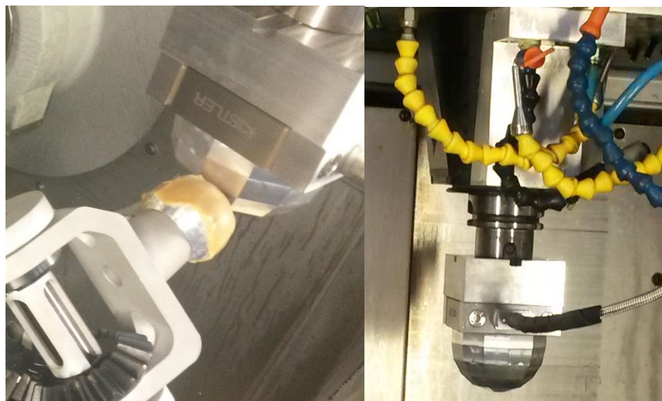
Figura 65 - Sensor de Força (Direita) Robô Aplicando Força (Esquerda) no Sensor.
