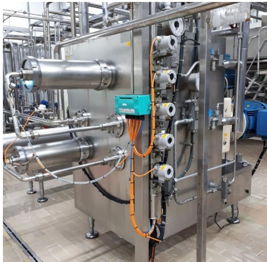
Figura 15 - Trocador de calor de superfície raspada (cristalizador). Fonte: original.
