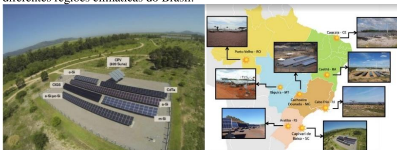
Figura 19 - Usina de Capivari de Baixo e os oito módulos de avaliação em diferentes regiões climáticas do Brasil.
