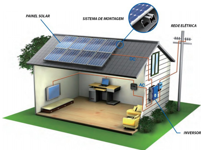
Figura 2.6: Sistema fotovoltaico conectado à rede. [3]
