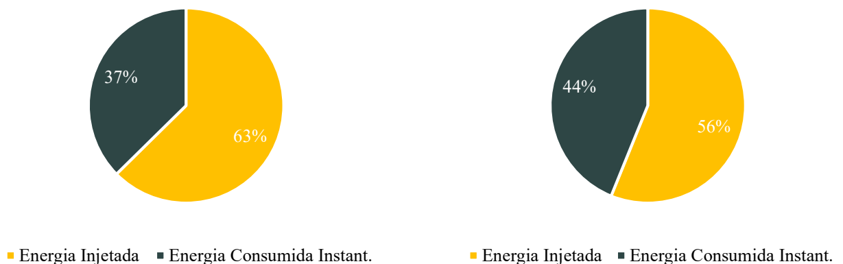
Figura 21 – Balanço de energia injetada e consumida instantaneamente, em média mensal anual, para os sistemas Turvo e Criciúma, respectivamente.
