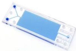
Figura 5 - Ilustração do chip microfluídico utilizado nos ensaios experimentais para avaliação da fonte de irradiação.
