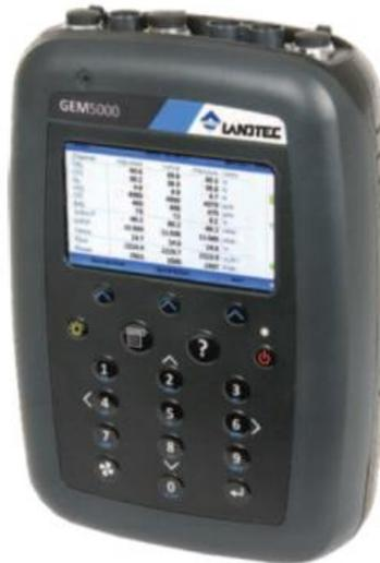
**Figura 13. Analisador de gases Landtec modelo GEM 5000.**
