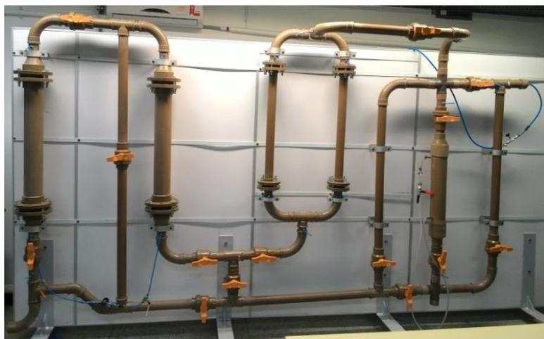
**Figura 10.** Painel de purificação de biogás por adsorção em carvão ativado.
