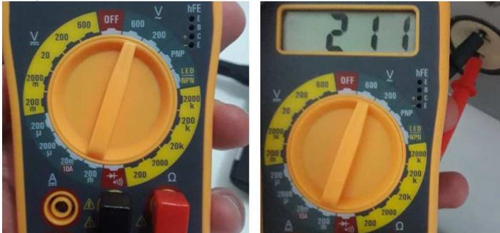
Figura 2: Medindo tensão de uma rede 220V em corrente alternada
