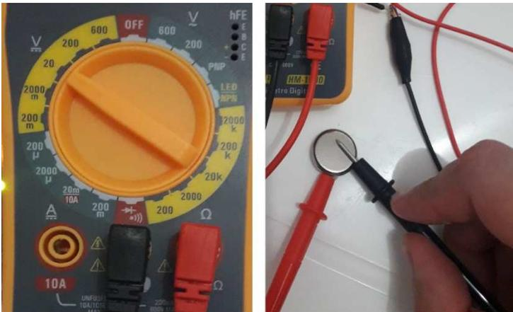
Figura 1: Medindo a tensão de uma bateria de 3V em corrente contínua
