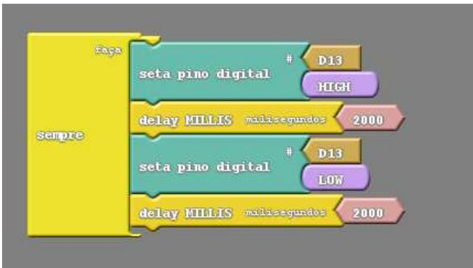
Figura 16: Estrutura de programação utilizando o Ardublock
