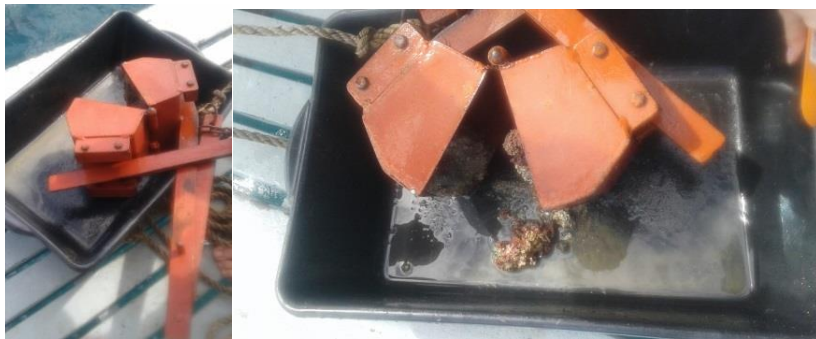
Figura 11 Amostrador de fundo do tipo van veen utilizado para coleta. É possível observar a presença de rodolitos no amostrador.
