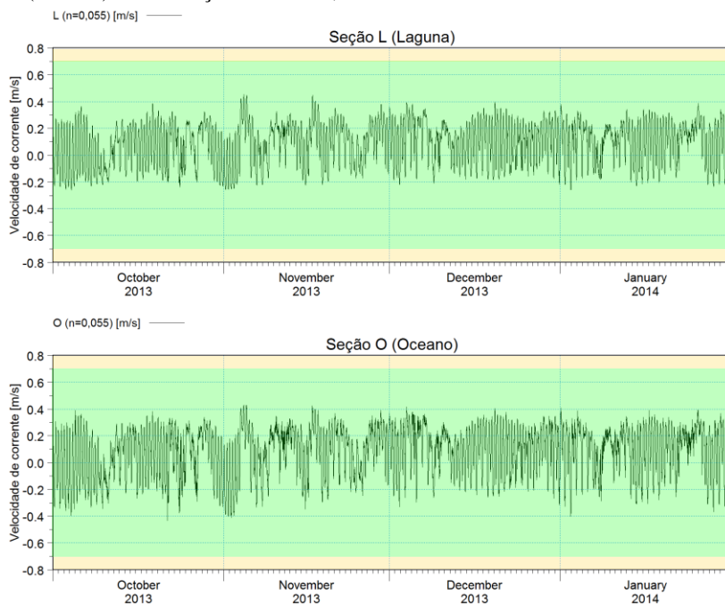
Figura 6.10 - Série temporal de velocidade de corrente nas seções L (Laguna) e O (Oceano) na simulação com n = 0,055 .
