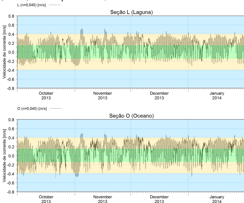
Figura 6.9 - Série temporal de velocidade de corrente nas seções L (Laguna) e O (Oceano) na simulação com n = 0,045 .
