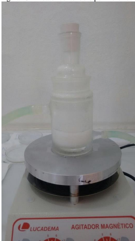
Figura 15 – Reator contendo o polímero fosforado após 4 h de agitação.
