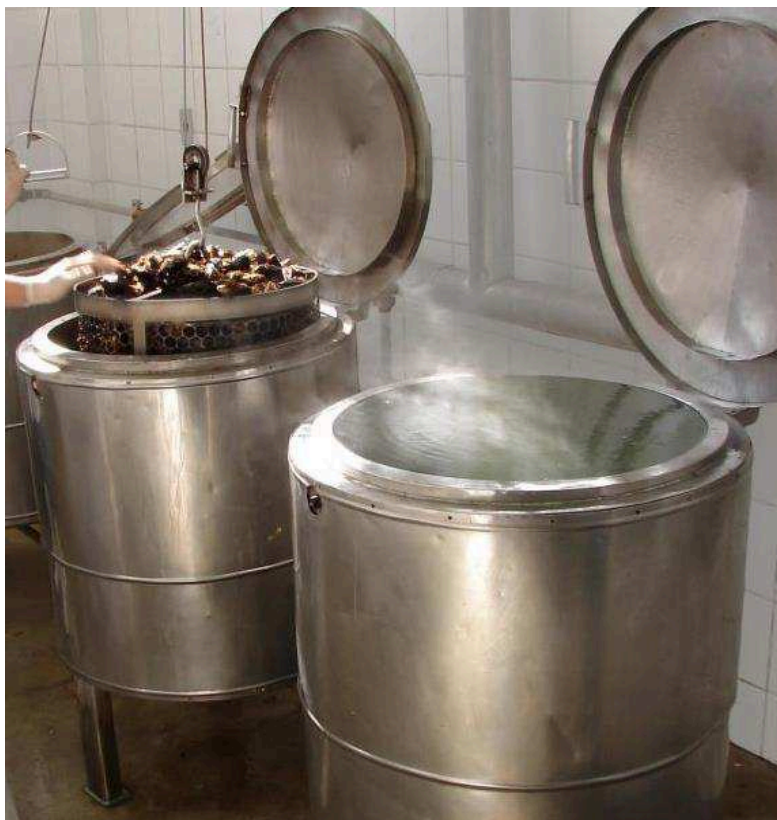
Figura 6 - Equipamento utilizado para o tratamento térmico de moluscos bivalves
