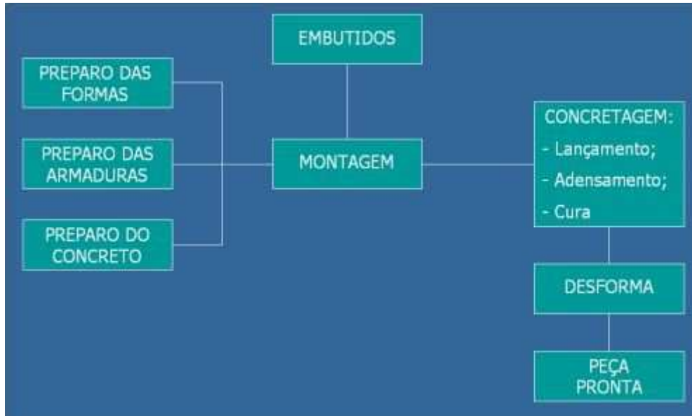
Figura 55: Processo de fabricação do concreto armado
