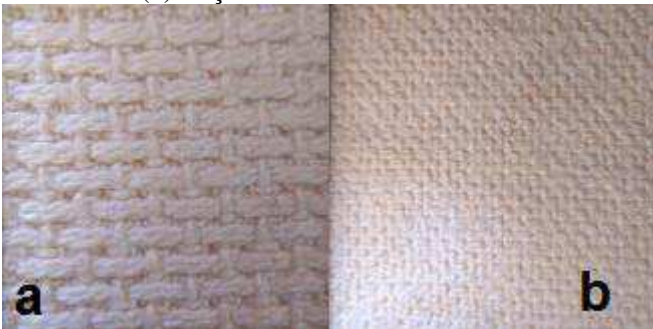
Figura 28 - Fotografia após o ensaio no pilling box da (a) jaqueta e (b) calça do kimono Stance®
