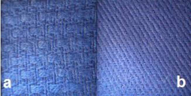
Figura 27 – Fotografia após o ensaio no pilling box da (a) jaqueta e (b) calça do kimono novo
