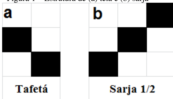
Figura 1 – Estrutura de (a) tela e (b) sarja
