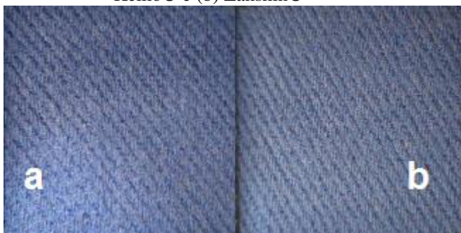
Figura 30 – Fotografia após o ensaio de pilling box das calças (a) Keiko® e (b) Zanshin®
