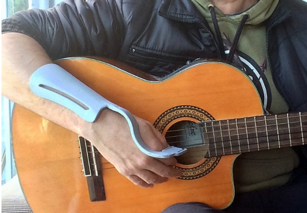
Figura 81: Teste de ergonomia com fixação da prótese por elástico e velcro.
