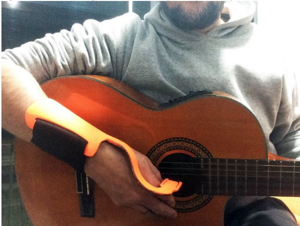
Figura 81: Teste de ergonomia com fixação da prótese por elástico e velcro.
