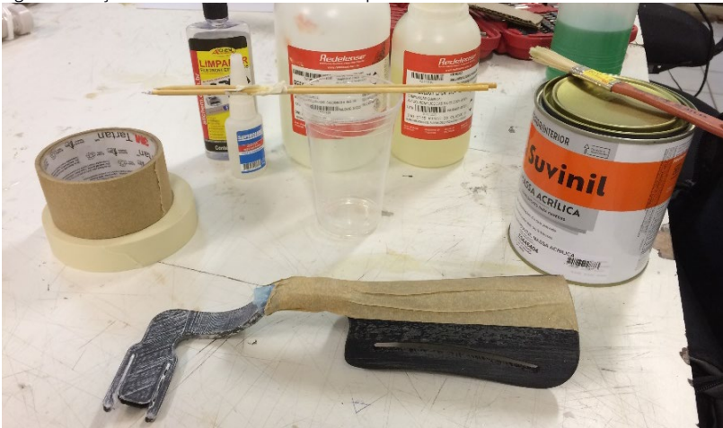
Figura 92: Peças unidas e coladas com resina epóxi.
