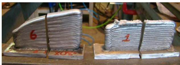
Figura 61: Influência do tempo de resfriamento entre deposições.
