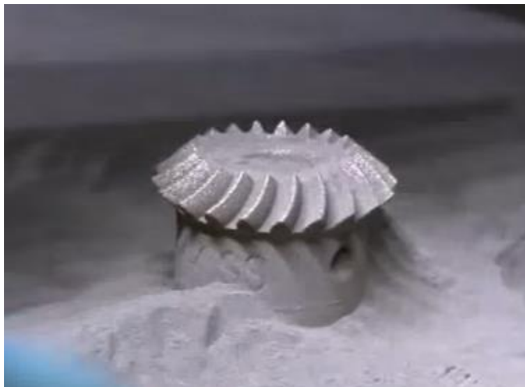
Figura 3: Peça manufacturada utilizando o processo DMLS. Fonte: YouTube.
