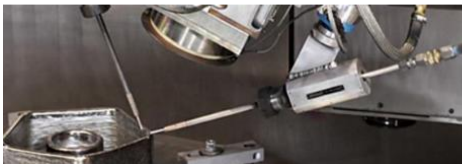
Figura 15: Processo EBAM com configuração de duplo arame. Fonte: Sciaky Inc.
