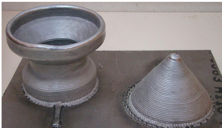
Figura 80: Sólidos obtidos utilizando parâmetros levantados e Gerador de Trajetórias desenvolvido.
