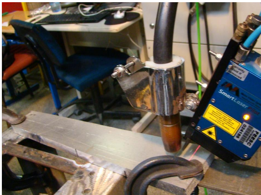
Figura 75: Setup inicial para manufatura de parede utilizando sistema de controle desenvolvido
