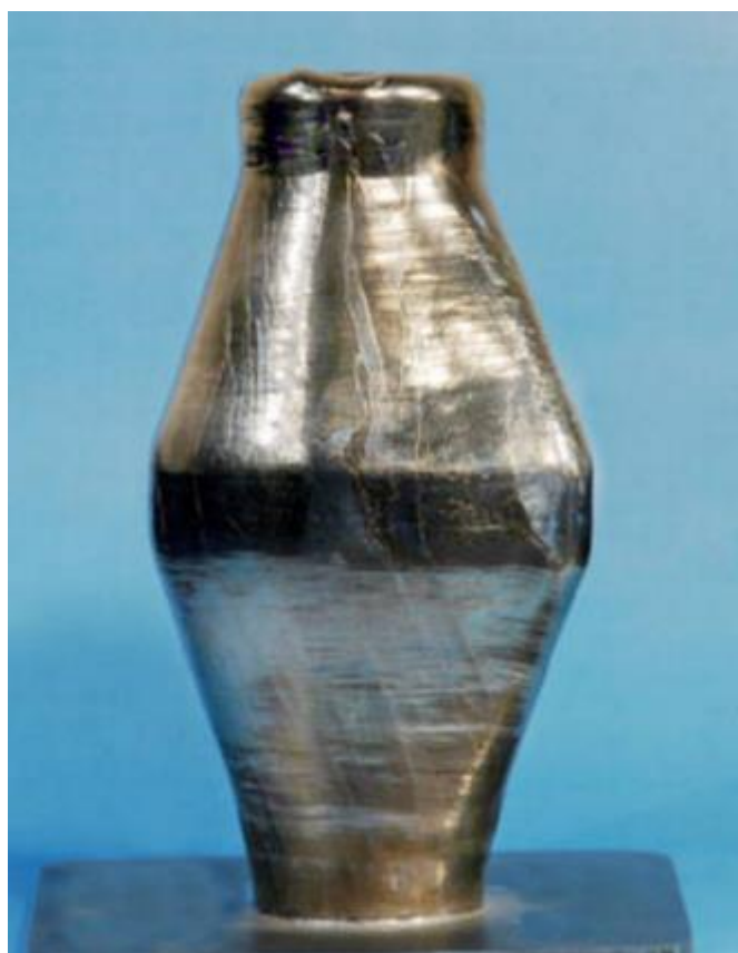
Figura 13: Peça estrutural manufaturada com o processo EBF. Fonte: [18]
