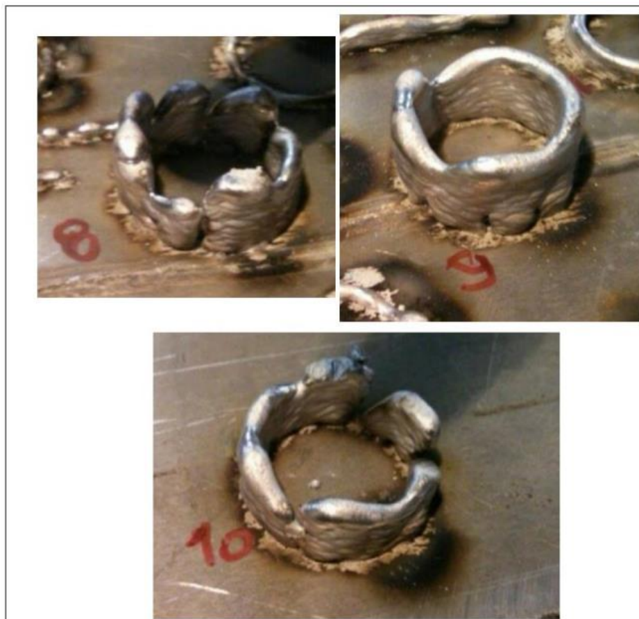
Figura 22: Movimentos circulares com variação de Velocidade de Soldagem e Incrementos em Z.
