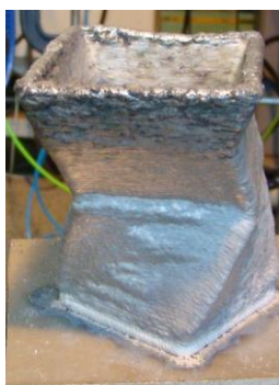
Figura 62: Efeito da perda da proteção gasosa devido ao aumento excessivo da DBCP.
