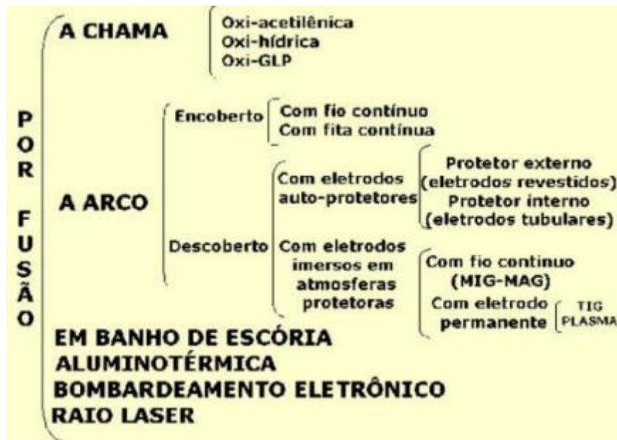
Figura 18: Processos de Soldagem por Fusão
