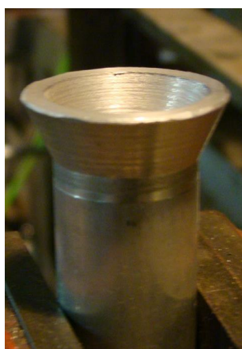
Figura: Manufatura do flange de um tubo de alumínio.
