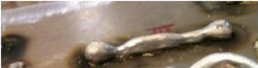
Figura 21: Tentativa de formação de parede com deposição em Direção Reversa
