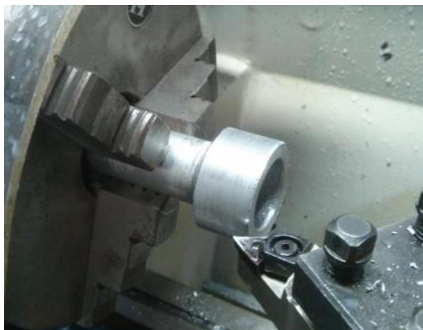
Figura 55: Utilização do Tubo Base para Usinagem
