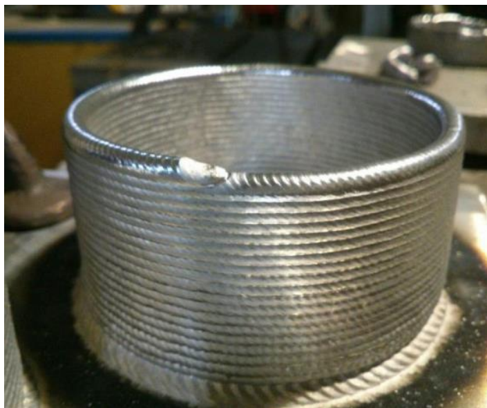
Figura 25: Primeira peça manufaturada com mudança de parâmetros elétricos durante o processo
