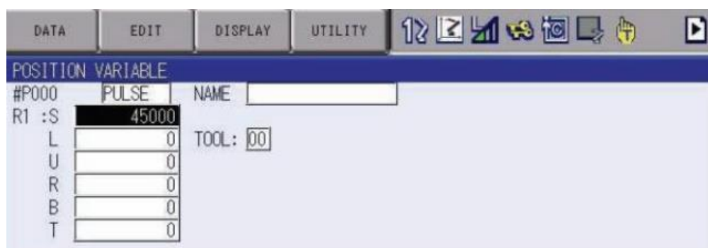
Figura 32: Registro de uma Variável de Posição em modo Pulso [25]
