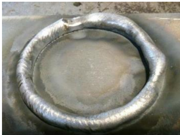
Figura 24: Processo de manufatura aditiva com dissipação de calor insuficiente
