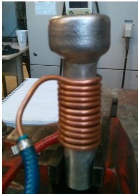
Figura 54: Serpentina de Cobre envolvendo o Tubo Base
