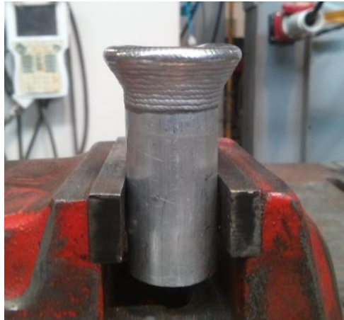
Figura 59: Peça com Transferência Metálica Estável
