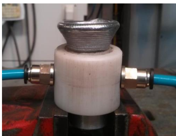
Figura 58: Peça com Transferência Metálica Estável e Sistema de Refrigeração
