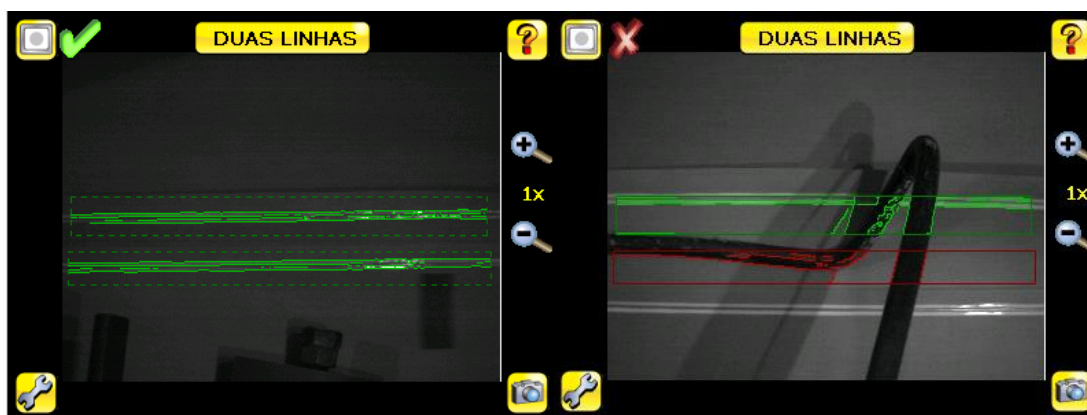
Figura 33: Exemplos de posicionamento das ferramentas. Correto (esquerda) e incorreto (direita).
