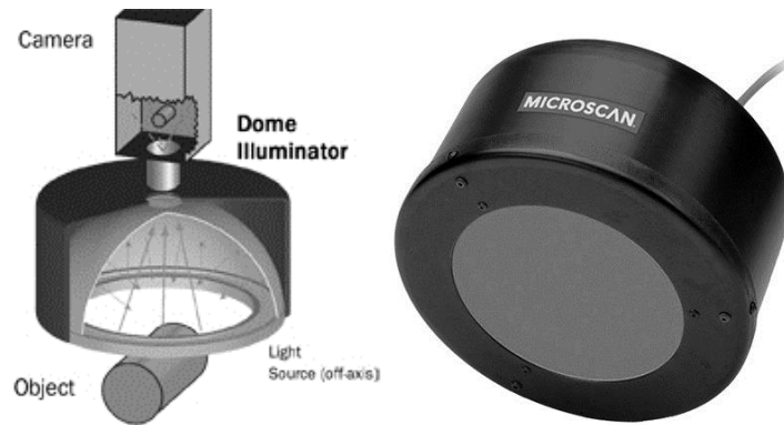
Figura 10: Funcionamento e exemplo da iluminação Dome light.
