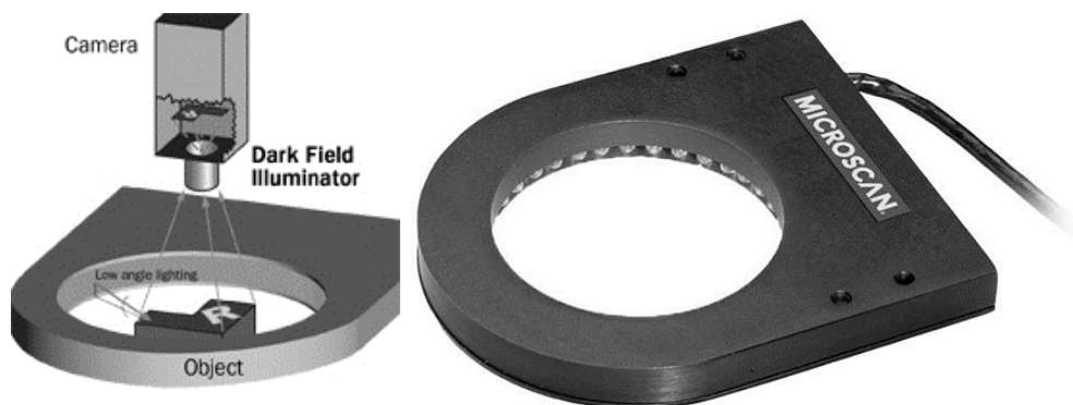
Figura 12: Funcionamento e exemplo da iluminação Campo Escuro.
