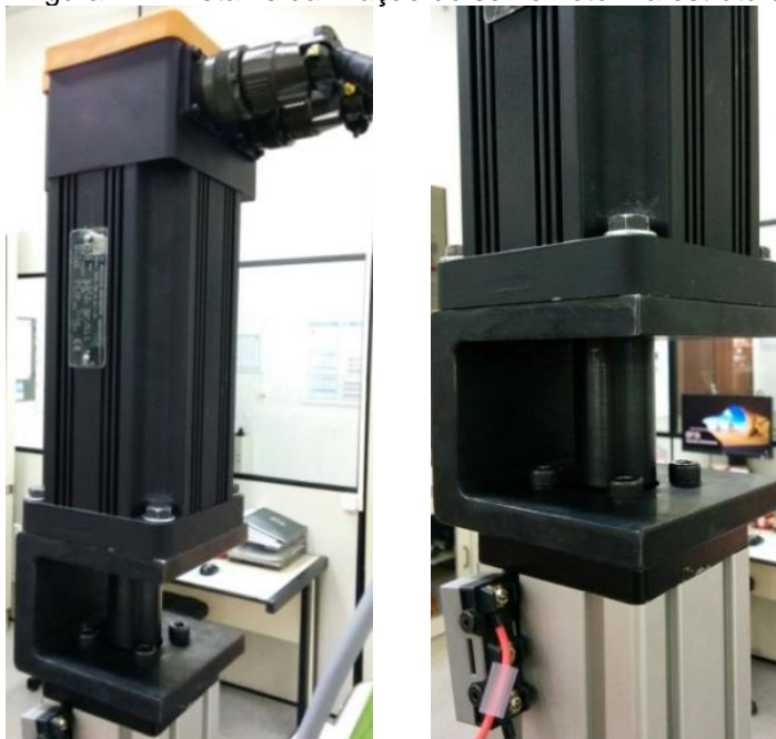
Figura 44 – Detalhe da fixação do servomotor na estrutura
