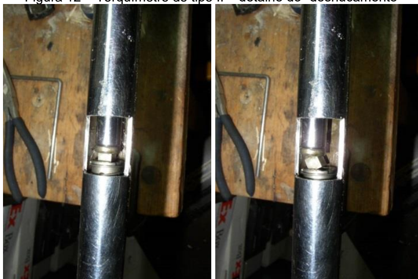
Figura 12 – Torquímetro do tipo II – detalhe do “desnucamento”
