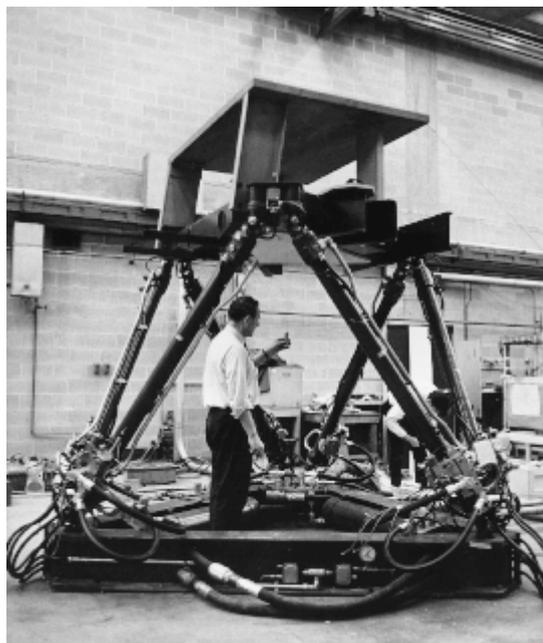
Figura 3 – Simulador de movimento patenteado por K. L. . Cappel [2]
