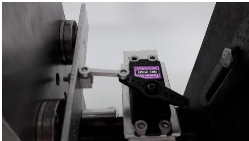
Figura 36: Acoplamento entre motor e sistema de reposicionamento. Fonte: Acervo pessoal.
