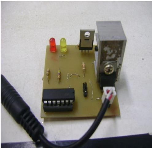
Figura 60 – Carregador de bateria (regulador de tensão 7808 com dissipador de calor).
