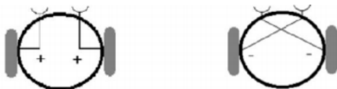
Figura 13 – Arquitetura de veículos de Braintenberg (à esquerda, temeroso e à direita, explorador)
