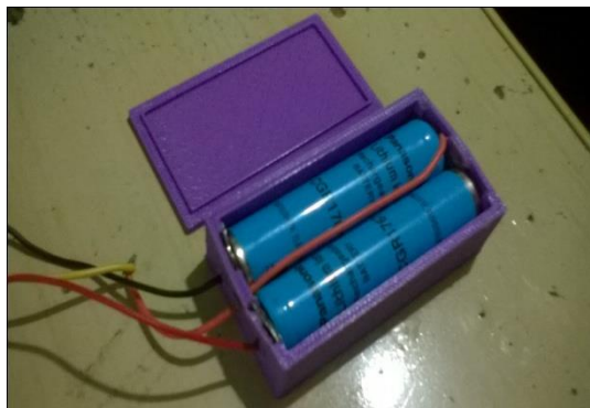
Figura 56 – Case e tampa da bateria para as células CGR17670A.
