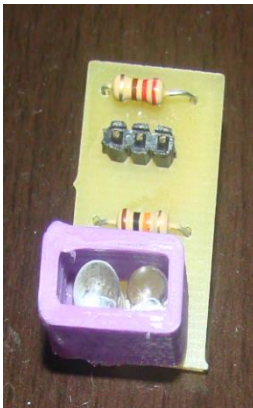
Figura 53 - Sensor óptico desenvolvido
