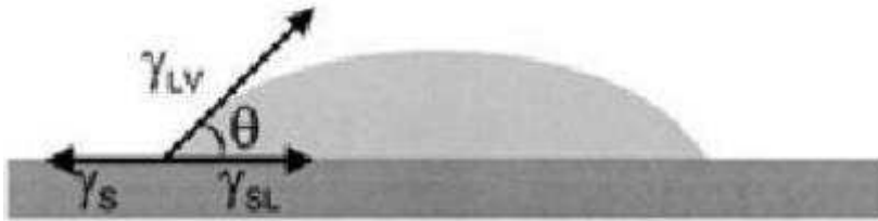
Figura 13 - Representação do ângulo de contato
