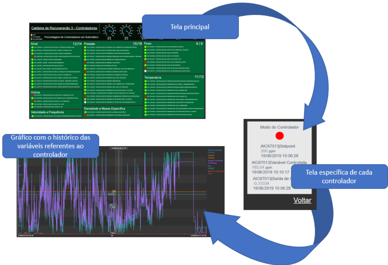
Figura 51 – Fluxo de operação realizado pelo supervisor para verificar problemas no controle dos equipamentos da caldeira
