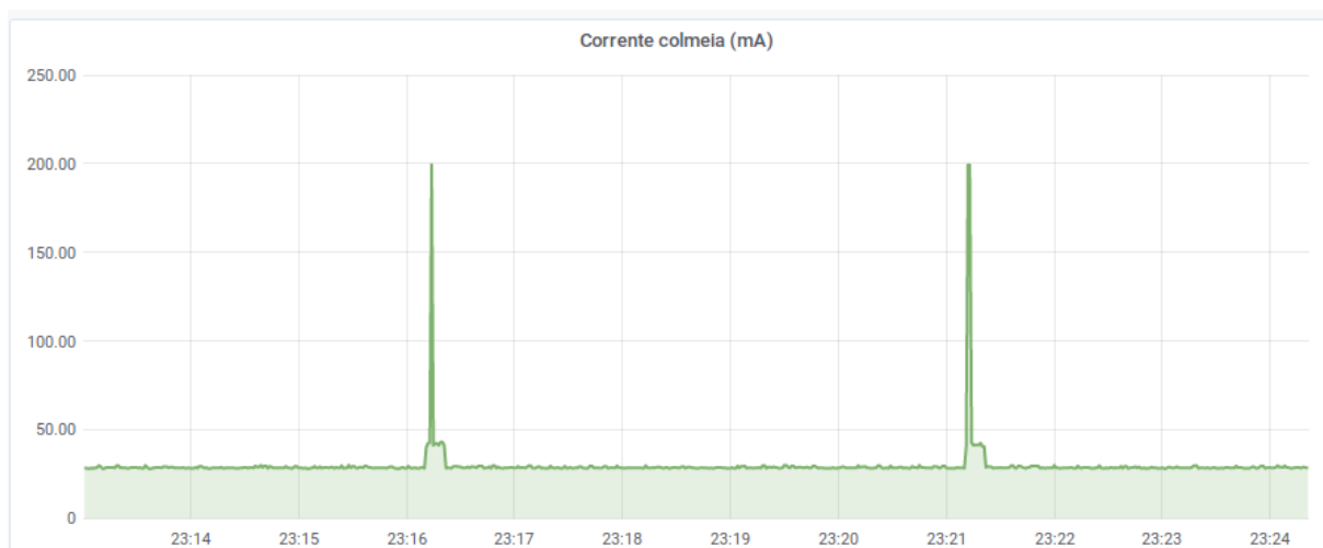
Figura 39 – Monitoramento da corrente no módulo colmeia para tempo entre transmissão de 5 minutos, adquirido pelo sistema MCO
