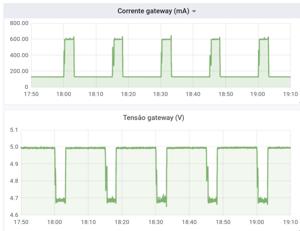
Figura 41 – Monitoramento da corrente e tensões no módulo gateway para tempo de wake-up de 15 minutos, adquirido pelo sistema MCO
