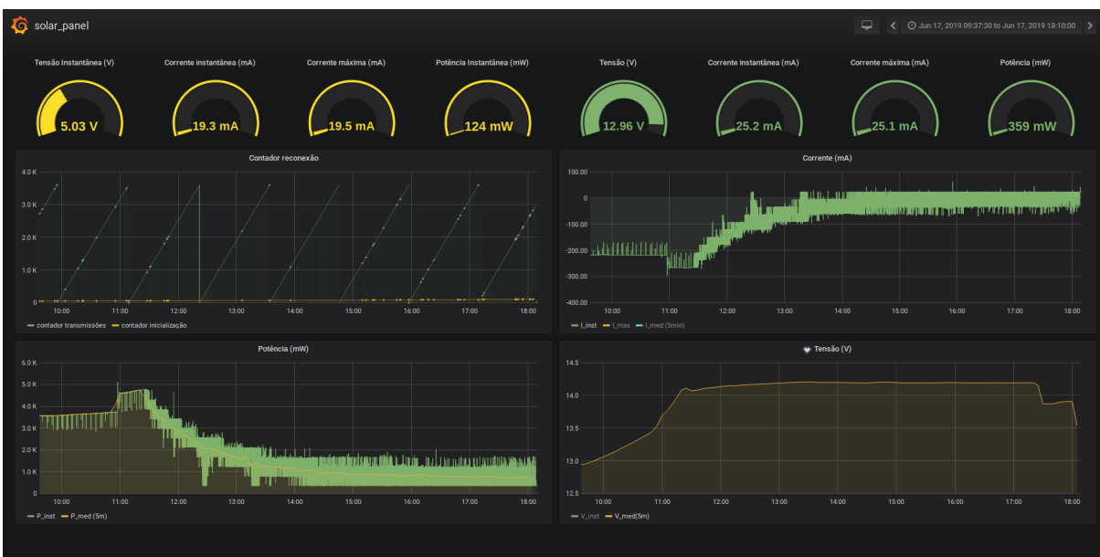
Figura 21 – Carga da bateria de 12V 1.2 Ah medido pelo MCO e visualizado no Grafana
