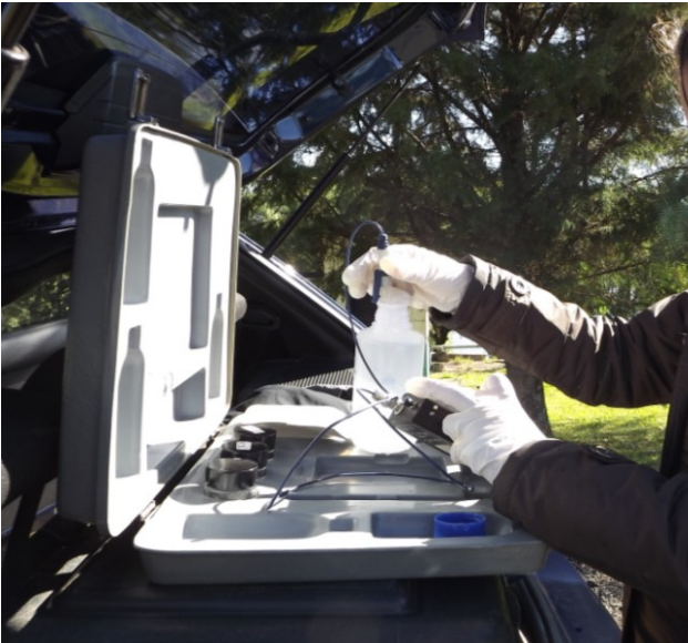
Figura 2.2: Equipamentos de trabalho em campo - Sonda Multiparâmetros, termômetro, peagâmetro, luvas, caixas de isopor, gelo, planilhas, etc. E os colaboradores nas coletas de amostras de águas dos poços profundos. Responsáveis pelas coletas e medições “ in loco ”, trabalho que só foi possível porque eles sacrificaram o seu descanso dos sábados para colaborar no levantamento de dados desse estudo. Ela realizou todo o árduo trabalho de laboratório também em horários de descanso, aos quais não tenho palavras para agradecer, pela dedicação, companheirismo e disponibilidade.
