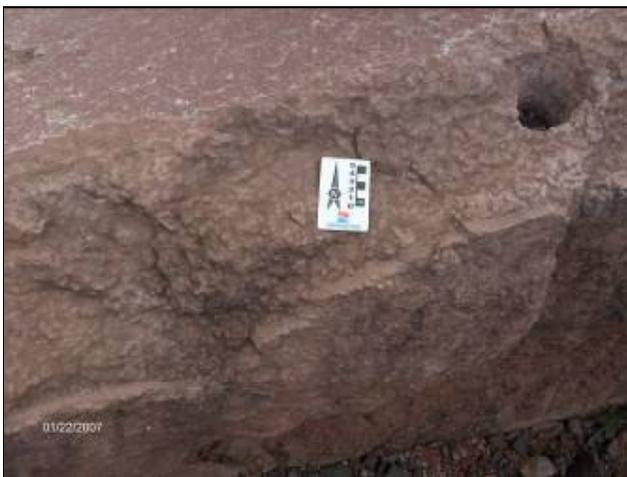
Figura 8: Arenito com aspecto de “pipocamento”, devido à influência do derrame superior
