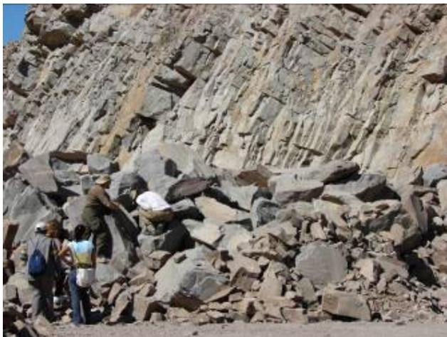
Figura 16: Pedreira de rochas ácidas, com intenso fraturamento.
