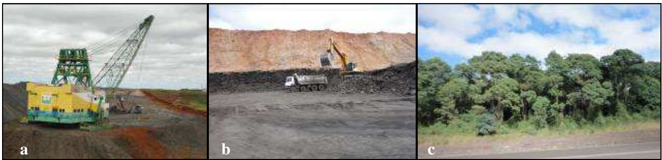
Figura 6: (a) Escavadeira “Marion”, utilizada pela Petrobras para retirada do capeamento estéril das camadas oleígenas do xisto betuminoso (Folhelho Irati) em São Mateus do Sul (PR). (b): Processo de carregamento do xisto betuminoso, que será britado e submetido a retortagem na usina da Petrobras em São Mateus do Sul (PR). (c) Área já minerada pela Petrobras em São Mateus do Sul, com recuperação da topografia e de espécies pioneiras nativas da mata atlântica (bracatinga). Fotos Luiz Fernando Scheibe.
