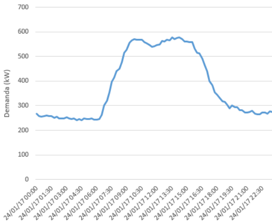
Figura 9 – Demanda de energia do dia 24 de janeiro de 2017 na região das Engenharias Civil e Química
