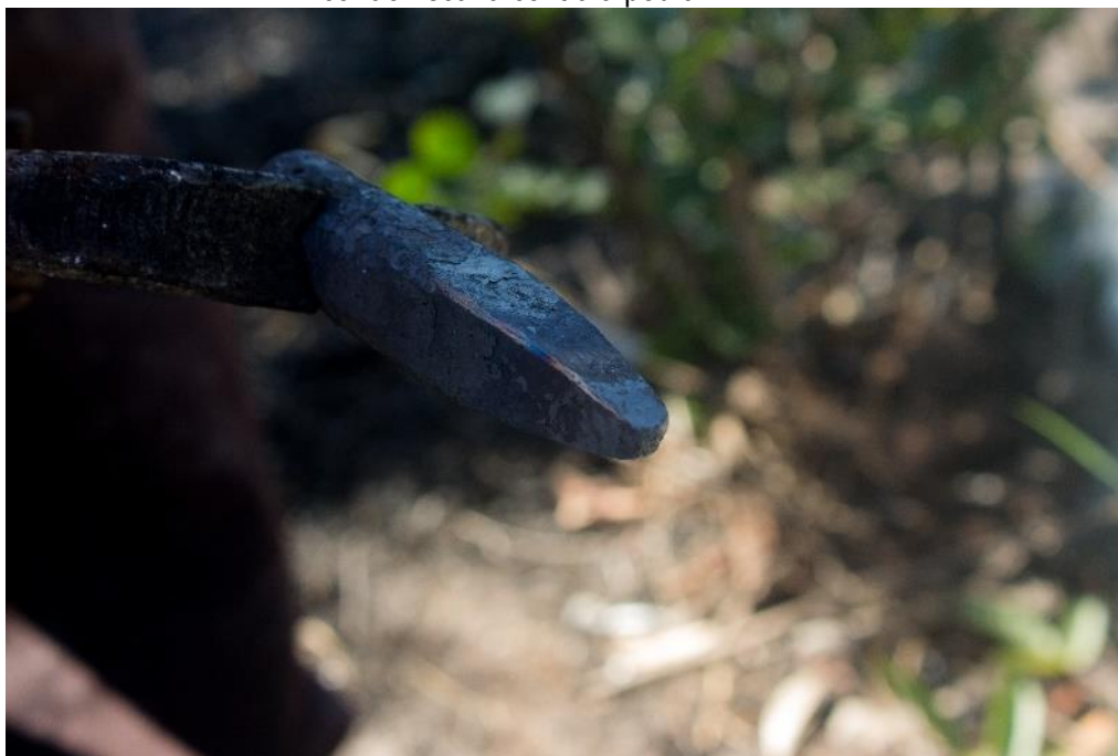
Figura 1 - A ferramenta está temperada (ou temprada) quando se verifica a linha furta- cor ao riscá-la contra a pedra.
