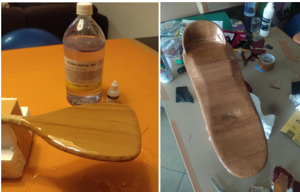
Figura 73 - Aplicação de resina e verniz de brilho.
