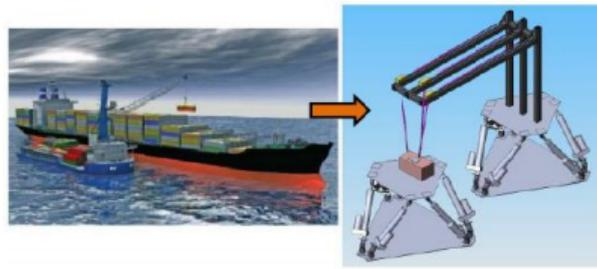
Figura 4 – Aplicação de uma plataforma Stewart em um simulador de transferência de carga entre navios - FONTE (AMARAL, 2015)
