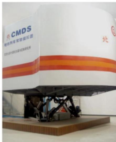
Figura 3 – Aplicação de uma plataforma Stewart em um simulador ferroviário - FONTE (AMARAL, 2015)
