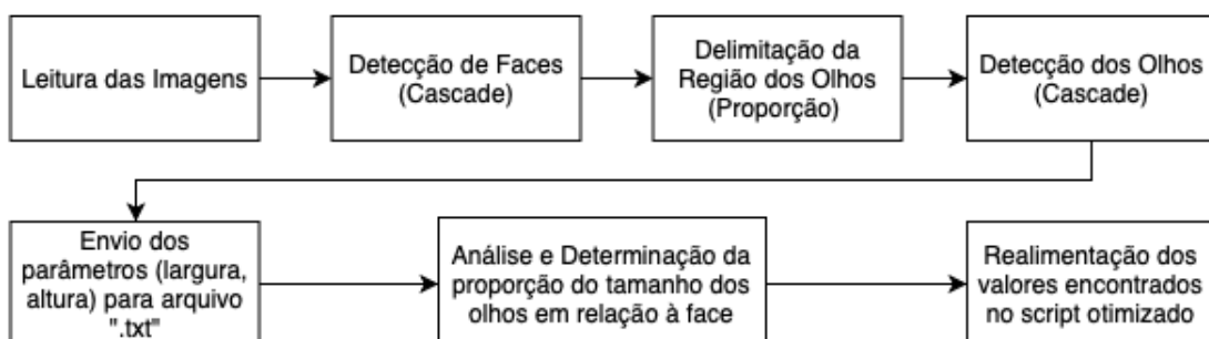
Figura 14 – Etapas para determinação de parâmetros para detecção de olhos.
