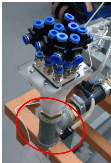
Figura 60 – Cotovelo na entrada – má distribuição do ar
