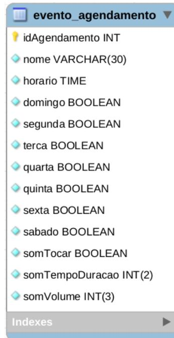
Figura 18. Esquema do banco de dados utilizado para armazenar o agendamento de eventos do nó *IoT*.
