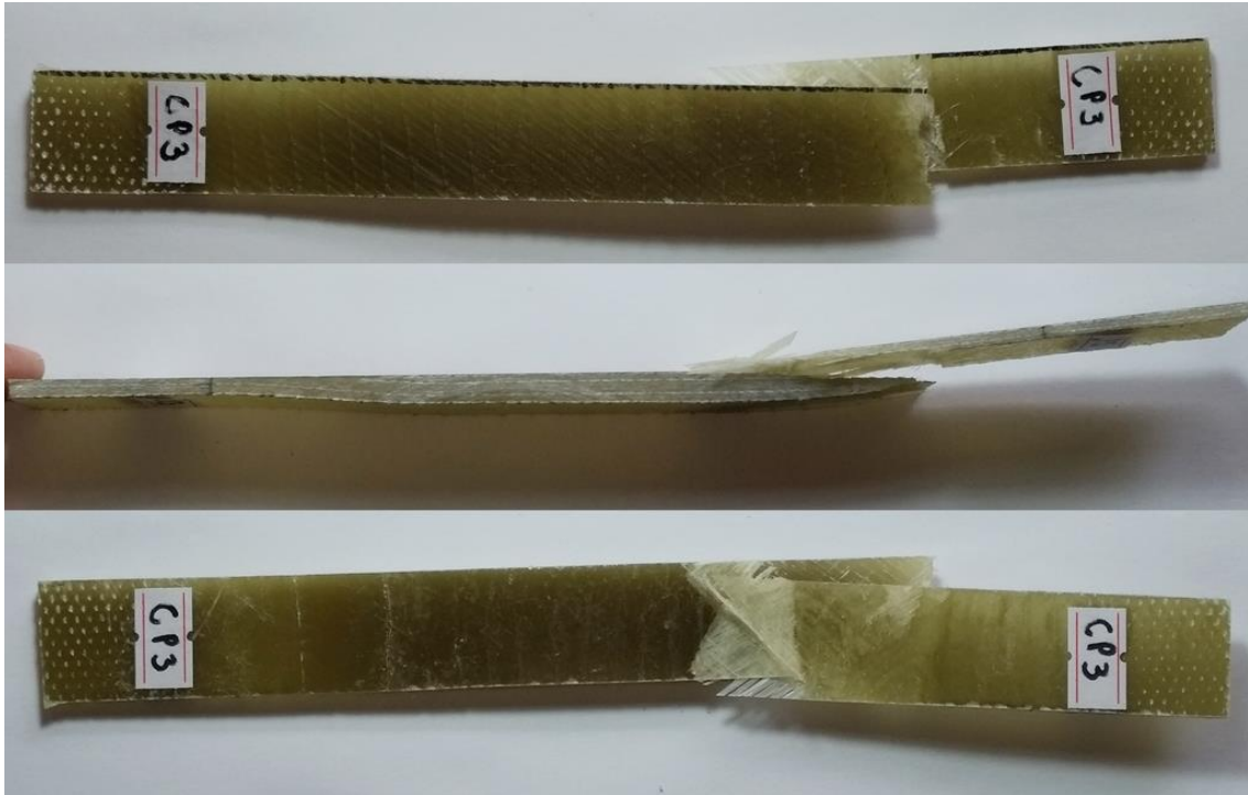
Figura 47 – Terceira característica de falha dos CP's com união de manta
