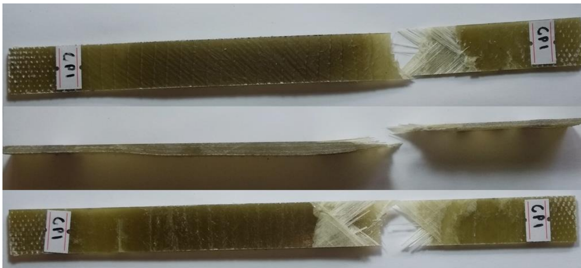
Figura 45 – Primeira característica de falha dos CP's com união de manta
