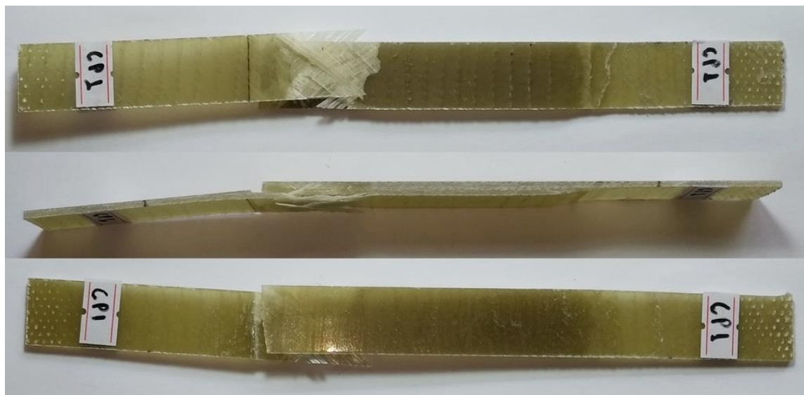
Figura 51 – Corpo de prova com mínima resistência ao cisalhamento
