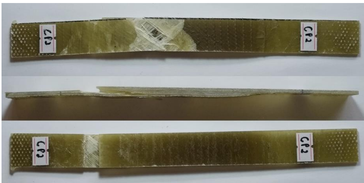
Figura 46 – Segunda característica de falha dos CP's com união de manta
