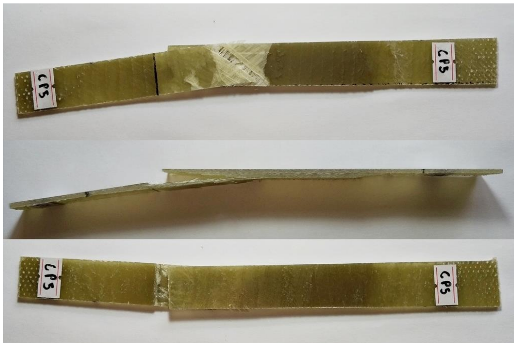
Figura 50 – Corpo de prova com máxima resistência ao cisalhamento
