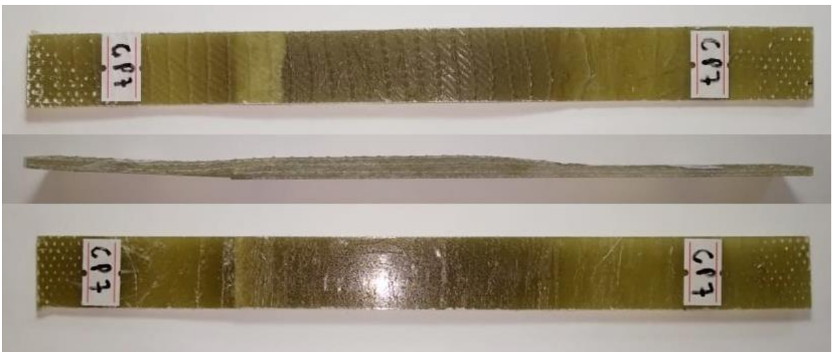
Figura 48 – Quarta característica de falha dos CP's com união de manta
