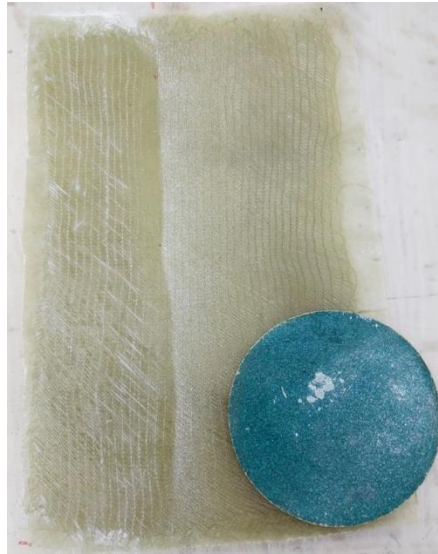
Figura 31 – Primeira etapa da laminação do perfil e preparação para a segunda etapa
