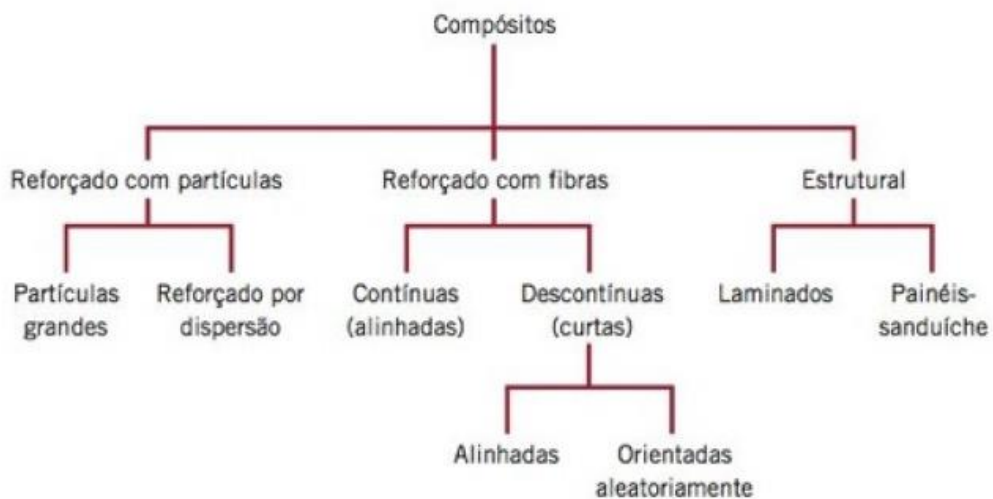
Figura 1 - Esquema de classificação dos três principais grupos de materiais compósitos
