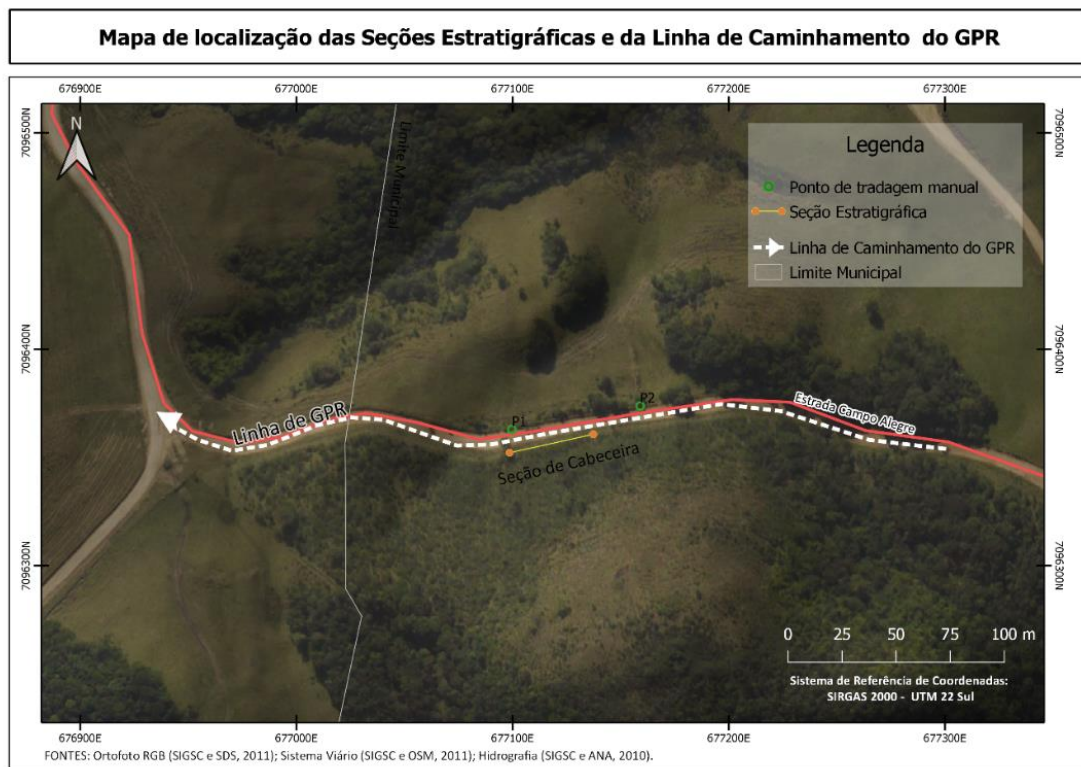
Figura 08: Posicionamento das seções estratigráficas e dos pontos (P1 e P2) onde foram realizadas as sondagens manuais. Em destaque ainda, a linha de caminhamento para aquisição do perfil de radar GPR.
