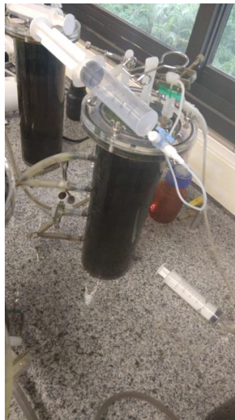
Figura 9 – Biorreator semi-contínuo de bancada utilizado do experimento.
